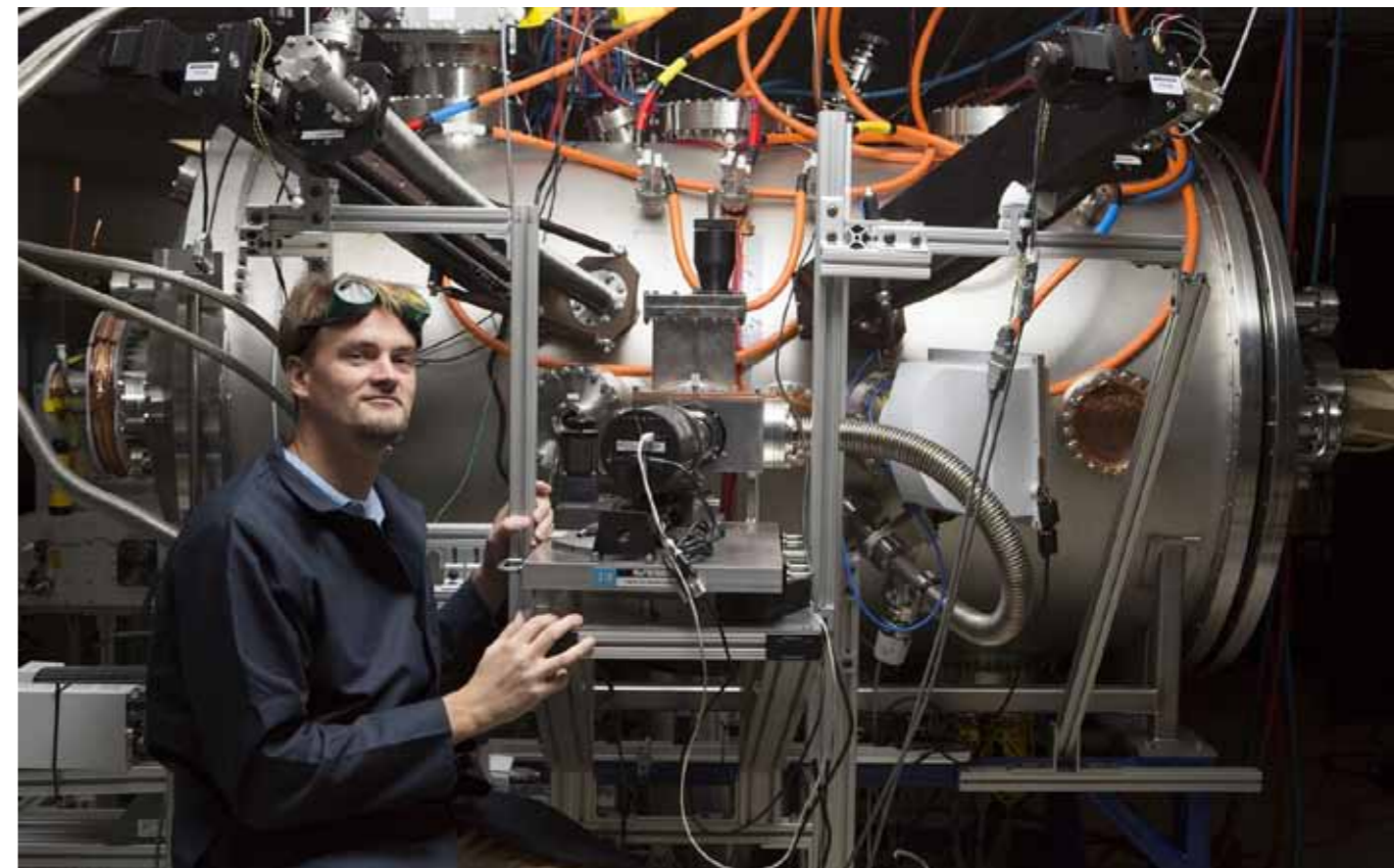
◀ Programový manažer Tom McGuire vedle T-4 zařízení, které reprezentuje první fázi vývoje kompaktního fúzního reaktoru. Výsledný reaktor bude mít cca 10 × 7 metrů, vejde se tedy na vagon nebo auto (Credit Lockheed Martin)
