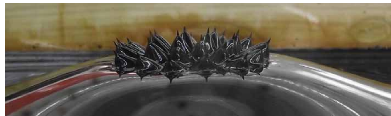
Ferokapalina Ferokapalina v mezeře mezi magnety
