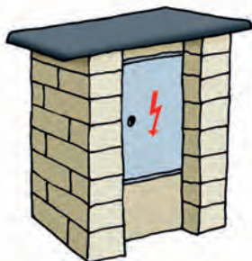
Distribuční rozváděč nízkého napětí
