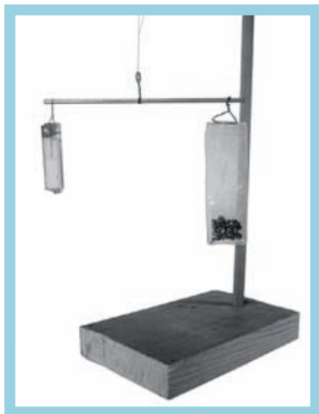
❖ Torzní vážky pro zkoumání magnetických vlastností látek se zavěšenými vzorky vody a cínu.
