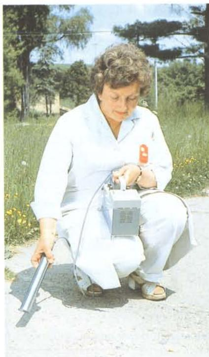
Měření scintilačním detektorem v terénu
