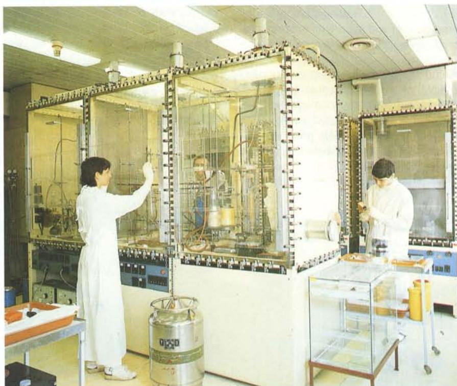
Práce s otevřenými zářicemi probíhá ve speciálních digestořích
