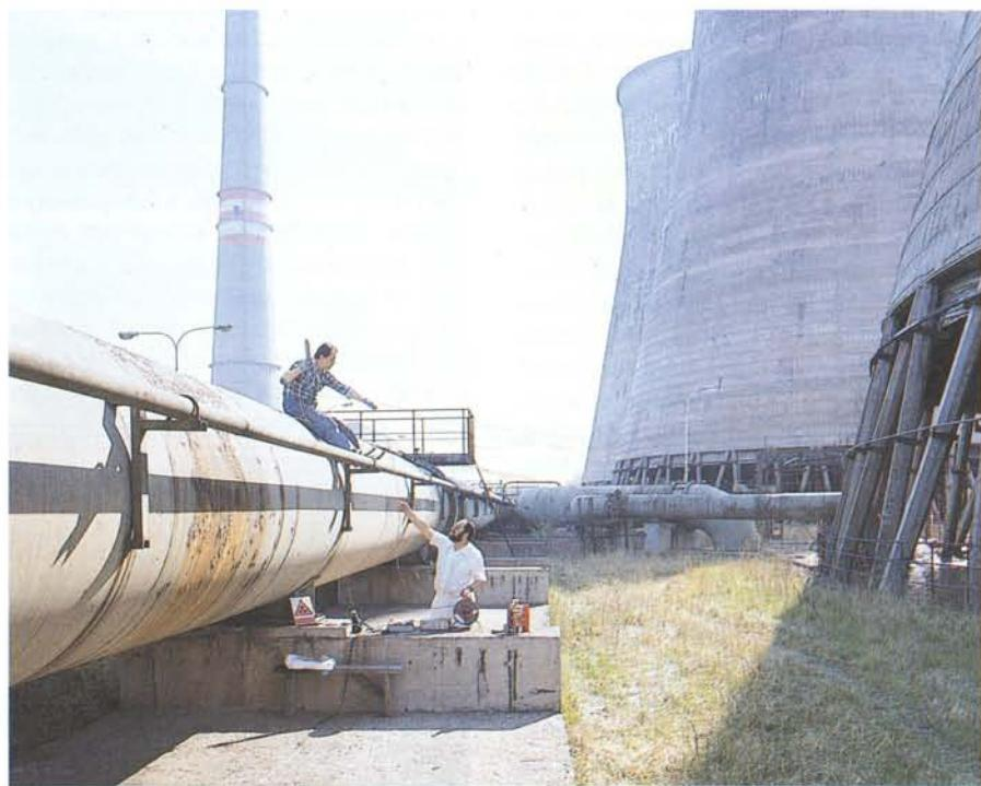
Měření objemových průtoků chladící vody v elektrárně pomocí radioindikátoru
