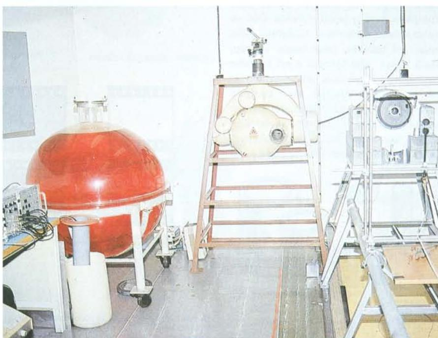
Aparatura pro absolutní měření metodou tzv. manganové lázně
