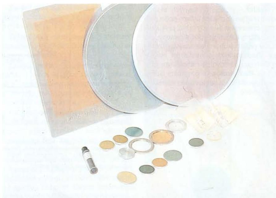
Ke kalibraci přístrojů se používají etalonové radionuklidů s přesně definovanou hodnotou aktivity, čistotou a geometrickým tvarem
