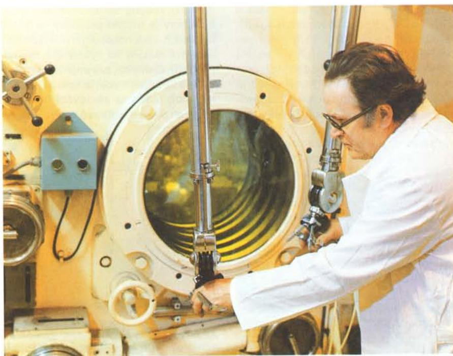
S vysoko radioaktivními materiály se pracuje v tzv. horkých komorách, a to pomocí manipulátorů
