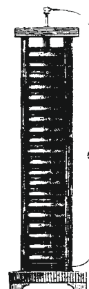
Historický elektrický článek – proslulý Voltův sloup. Sloupec stříbrných a zinkových kotoučů umístěných na sobě a proložených stejně velkými kotouči vlhké plsti.
