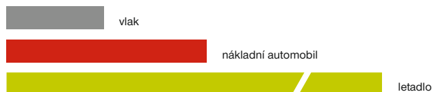
Relativní spotřeba paliva na tunokilometr – letadlo spotřebuje 60× více paliva na dopravení tuny nákladu než nákladní automobil
