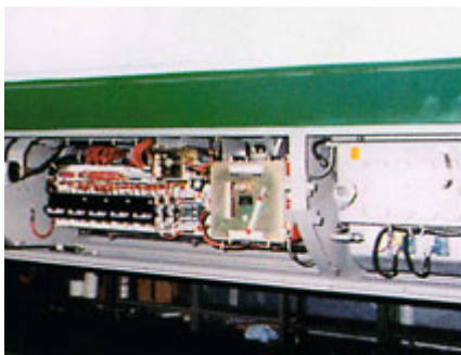
Vestavěný modul s tyristorovými měniči u lehkých článkových expresů a elektrických jednotek bývá umístěn pod rámem každého vozu
