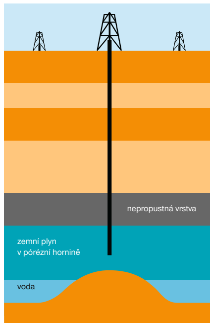
Podzemní skladování zemního plynu ve zvodnělých vrstvách
