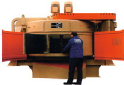
Míchačka na výrobu aglomerátu či stabilizátu
