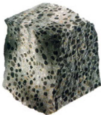
Betonový blok s použitím popílkového kameniva
