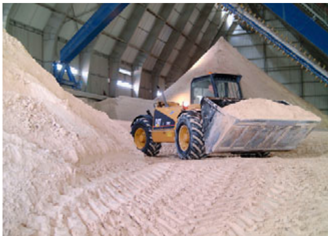
Sklad energosádrovce v Elektrárně Mělník
