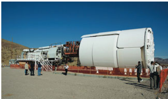
Razicí štít pro připravované konečné úložiště vyhořelého paliva v nevadském pohoří Yucca Mountains v USA. Úložiště je umístěné stovky metrů pod povrchem, pojme na ploše 1 400 akrů celkem 77 tisíc tun radioaktivního odpadu. (Kontejnery uložené ve vyrubaných tunelech budou 50 let monitorovány na těsnost a poté budou původním vytěženým vulkanickým popelem a prachem, který byl dočasně uložen na povrchu, zasypany.)
