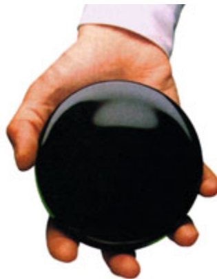
Takovéto množství zesklavatělych vysokoaktivních odpadů by vzniklo, kdyby člověk po celý svůj život spotřebovával jen elektřinu vyrobenou v jaderných elektrárnách
